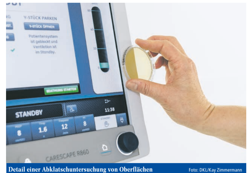
Detail einer Abklatschuntersuchung von Oberflächen
